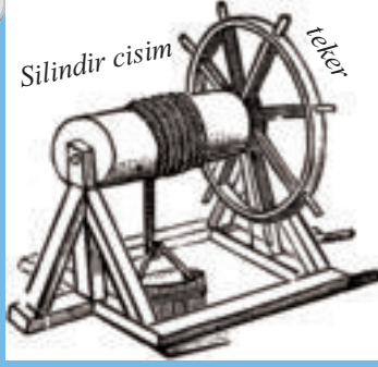
Su kuyularında kullanılan makaranın mekanizması
