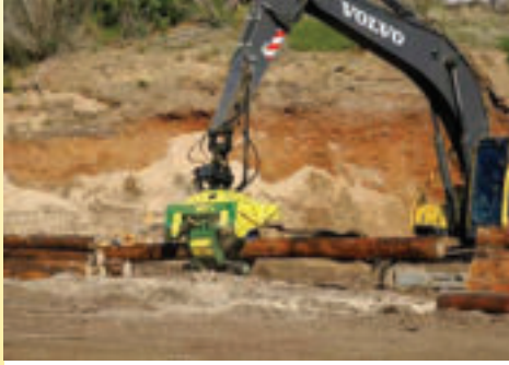
Odun kesme ve nakletme makinesi
