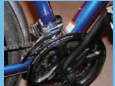
Ön vites – pedal, krank kolu, zincir ve dişli çark
